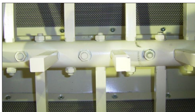
Желоб остеоломателя с поверхностью с перфорированными ячейками и ударные прямоугольные штифты
